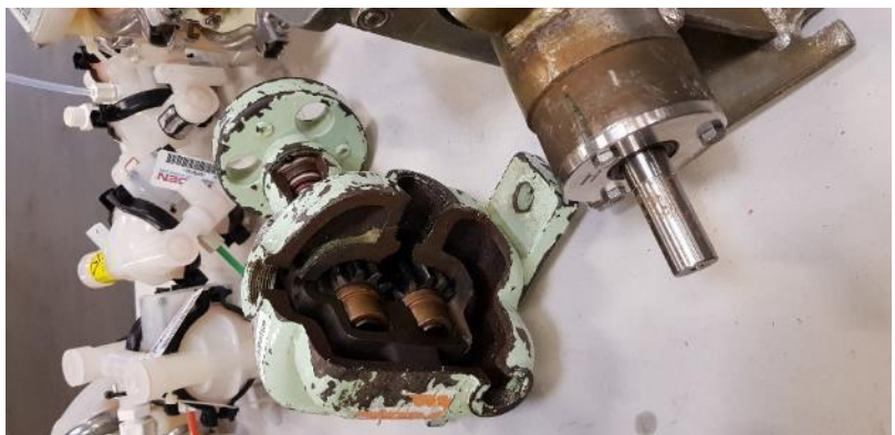
Querschnittsmodell einer Zahnradpumpe
